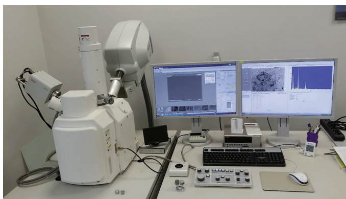
Fot. 6. Badanie przy użyciu mikroskopu skaningowego Hitachi UHR FE-SEM SU 8010
