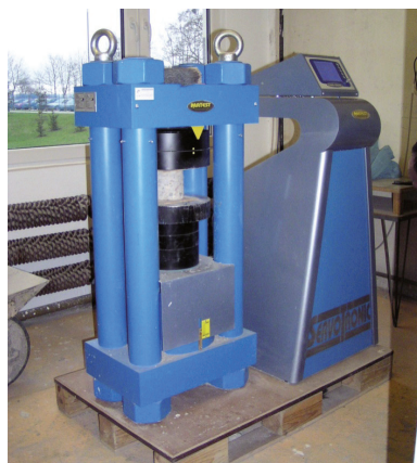
Fot. 4. Maszyna wytrzymałościowa do prób statycznych MATEST
