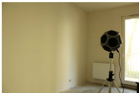
Fot. 15. Badana ścian oraz głośnik
