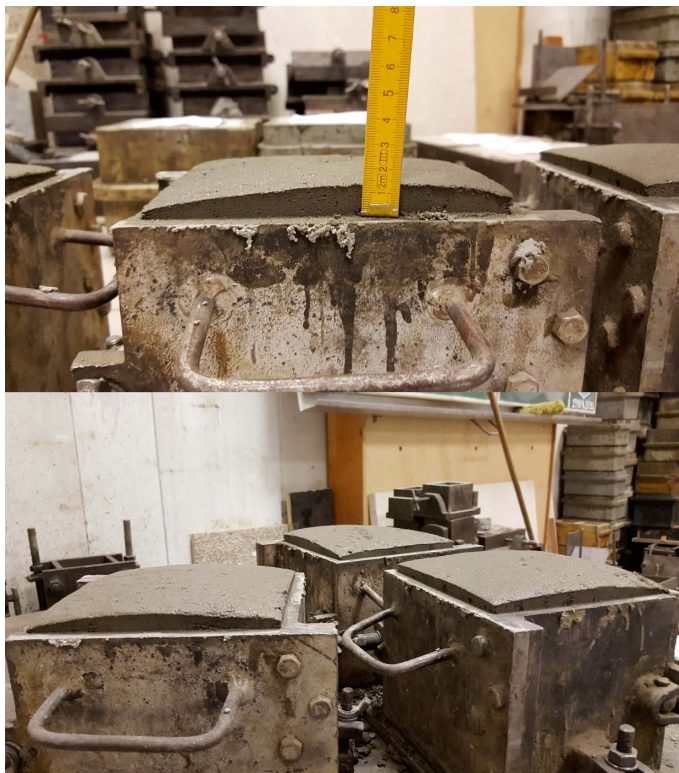
Fot. 1. Ekspansja próbek betonowych po 60 minutach od kontaktu cementu z wodą
