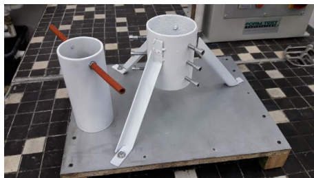
Fot. 4. Stanowisko do obciążania próbek
