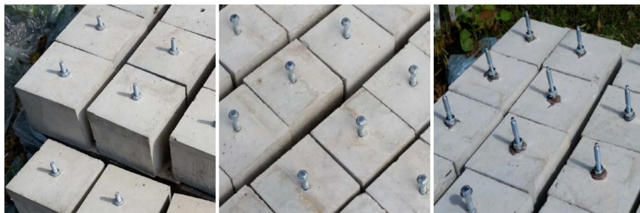
Fot. 1. Kotwy w próbkach betonowych (od lewej): segmentowe (HST3 M10x100), wkręcane (HUS3-H M10x100), chemiczne (HIT-V 5.8 M10x95)
