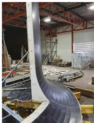
Rys.16 a) Test dopasowania form zewnętrznych etapu 2 b) Test dopasowania form wewnętrznych etapu 2
