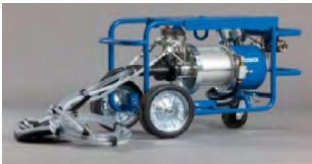
przykład pompy do iniekcji dwuskładnikowych
