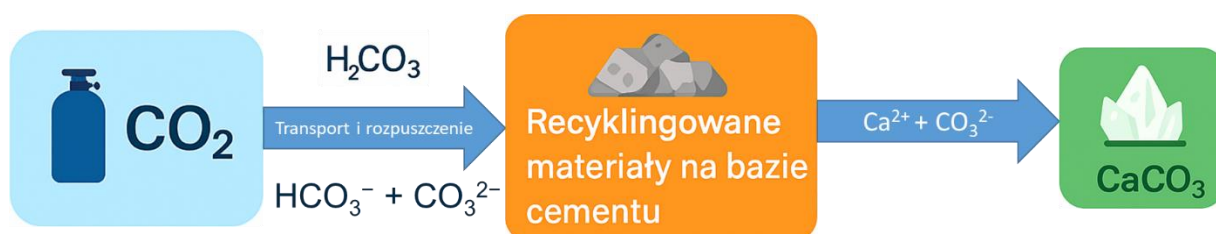
Rys.1. Ścieżki reakcji \text{CO}_2 z recyklingowanymi materiałami na bazie cementu [19].
