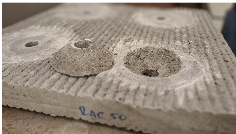
Rys. 6 Badanie pull-out betonu drukowanego
