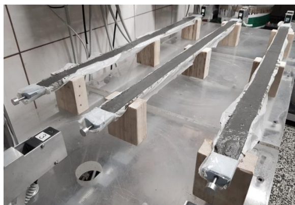
Rys. 4. Stanowiska badawcze do badania skurczu druku 3D: a) wariant 1 - próbki uformowane poprzez wytłaczanie pojedynczych warstw materiału z maszyny przyrostowej, bez dodatkowych zabiegów zagęszczania; b) wariant 2 - próbki zaformowane w półokrągłych korytkach liniowych i zagęszczone z wykorzystaniem stolika wibracyjnego.
