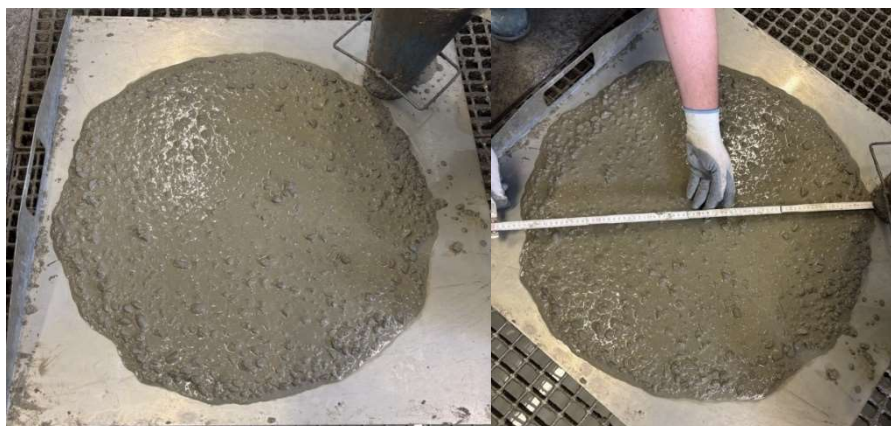
Rys. 1. Badanie konsystencji betonu metodą rozplywu stożka wg PN-EN 12350-8 [11]
