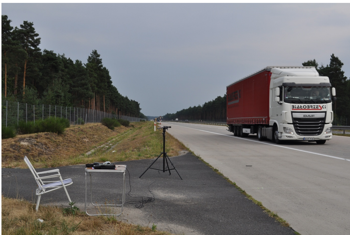
Rys. 1. Widok stanowiska badawczego pomiaru hałaśliwości nawierzchni metodą SPB.
