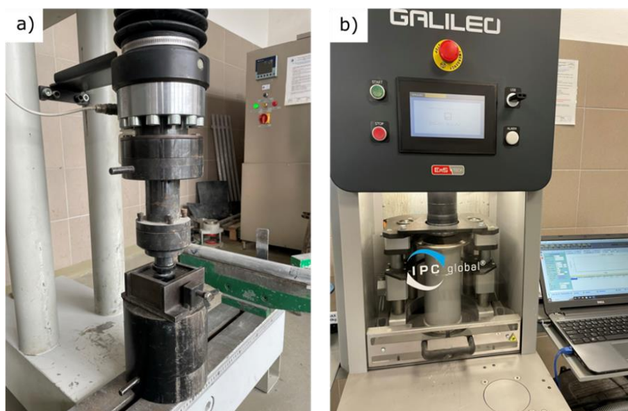
Rys.3. Wykonywanie próbek betonu barwionego a) formowanie próbek za pomocą prasy hydraulicznej b) formowanie za pomocą prasy żyratorowej [materiały własne]
