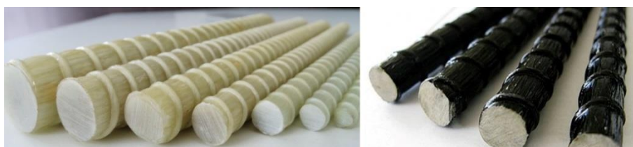
Rys. 4. Przykład prętów GFRP (a) i CFRP (b) [21]
