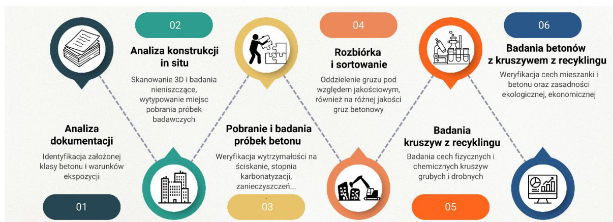
Rys. 1. Proponowany algorytm oceny kruszywa z recyklingu
