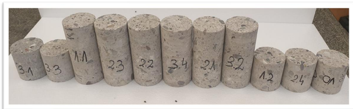
Rys. 4. Przykład odwiertów wykonanych w celu oceny charakterystycznej wytrzymałości na ściskanie
