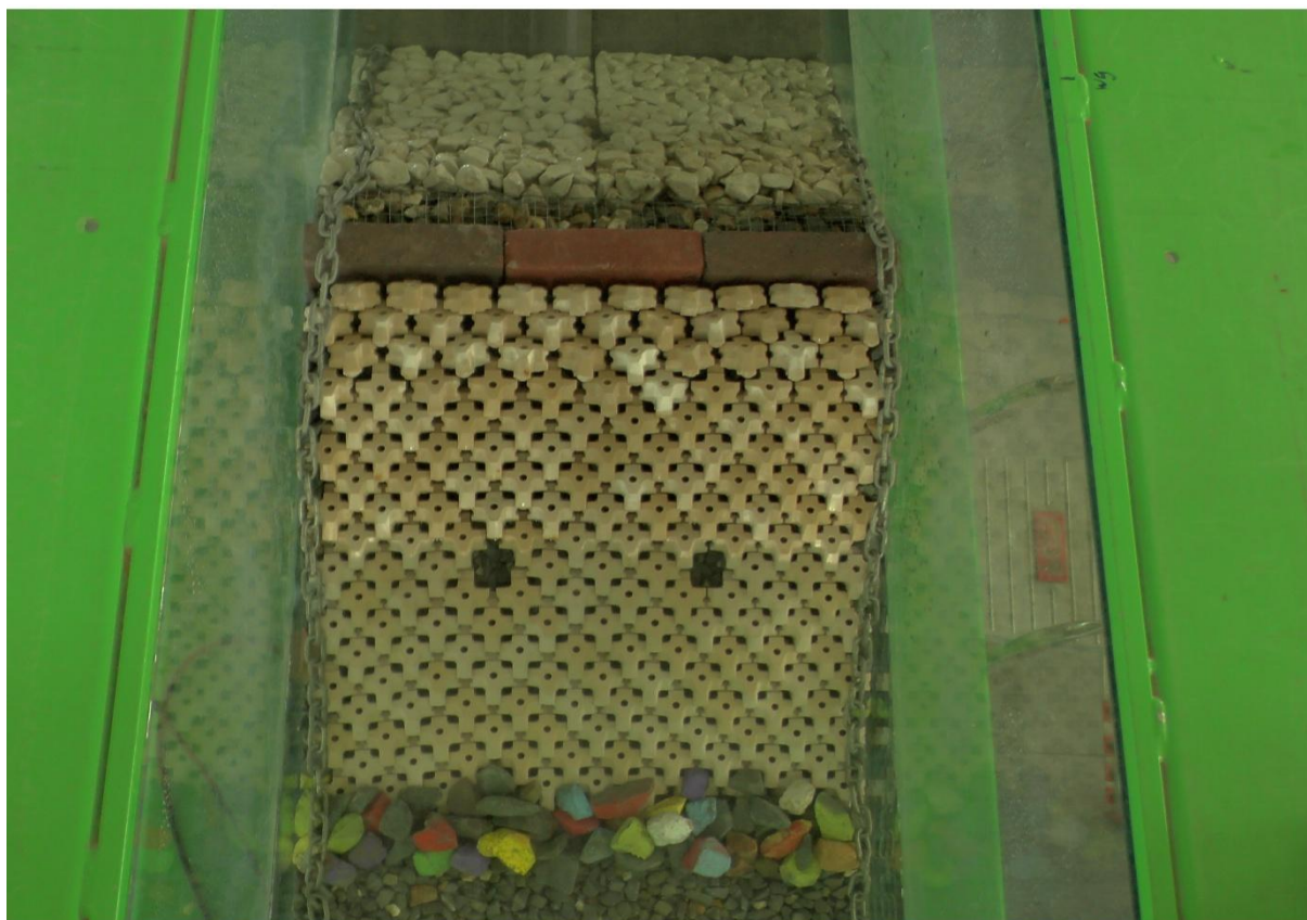
Zdjęcie 5: Test modelu z dwoma usuniętymi elementami
