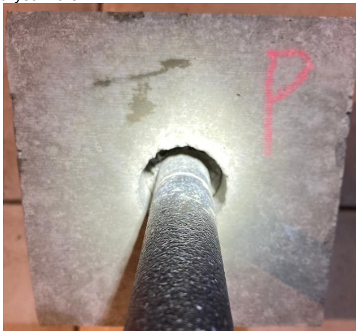
Rys. 3. Próbkki po badaniu wytrzymałości na wrywanie.
