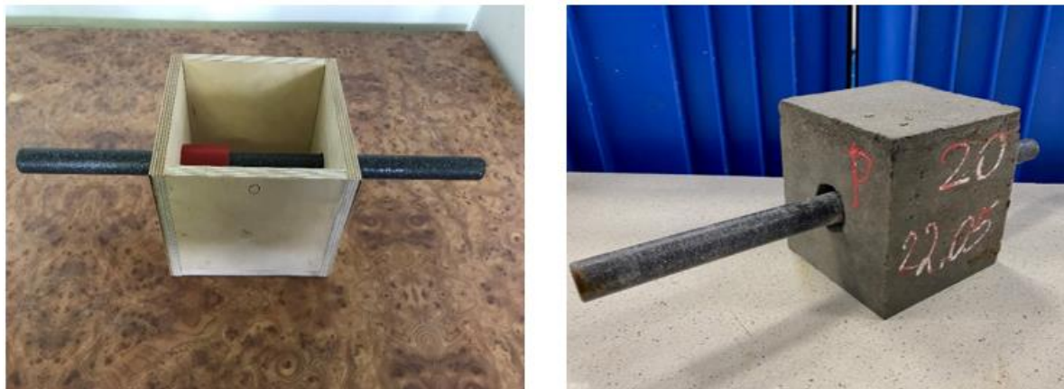
Rys. 2. Forma oraz obiekt badawczy do wykonania oznaczenia wytrzymałości na wrywanie - z lewej forma, z prawej obiekt przygotowany do badań.
