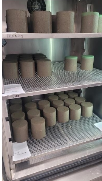
Rys. 8. Zaformowane próbki przechowywane w komorze klimatycznej przez 24 godzinny okres wstępnego dojrzewania
