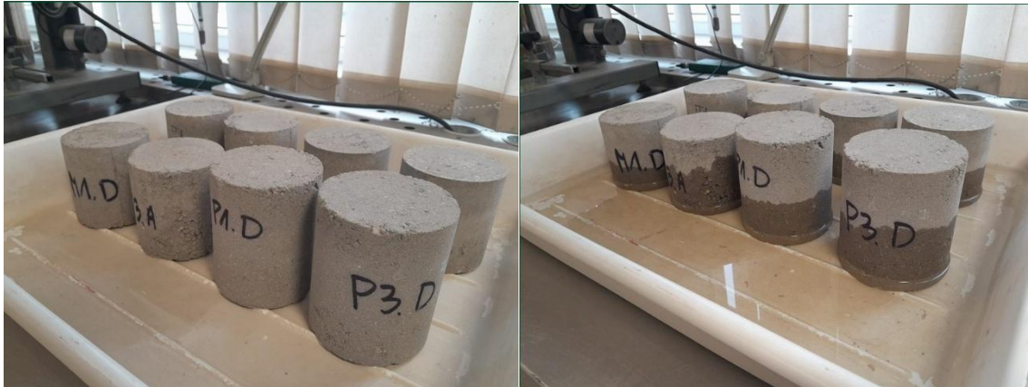
Rys. 11 i 12 Wygląd próbek podczas testu podciągania kapilarnego
