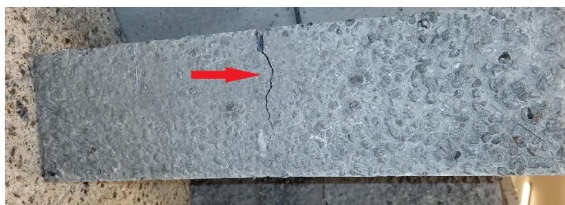
Fotografia 6. Próbka z betonu lekkiego po badaniu wytrzymałości resztkowej na rozciąganie przy zginaniu. Strzałką zaznaczono nacięcie i pęknięcie próbki.
