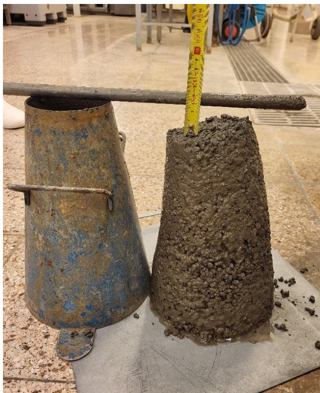
Fotografia 3. Badanie konsystencji betonu lekkiego metodą opadu stożka
