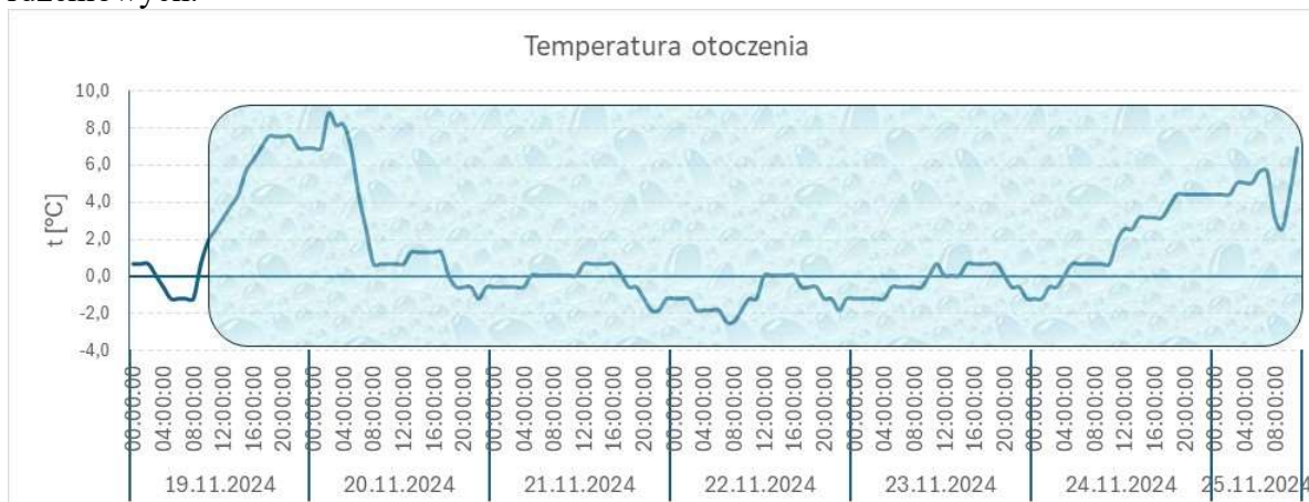
Rys. 3. Temperatura otoczenia w czasie dojrzewania betonu z prób technologicznych
