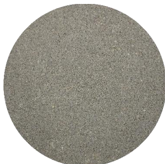
Rys 26. Przełam próbki CEM II/B-S 42,5 R-NA
