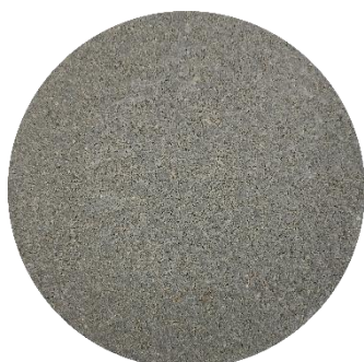
Rys 23. Wygląd powierzchni licowej CEM II/A-LL 42,5 R
