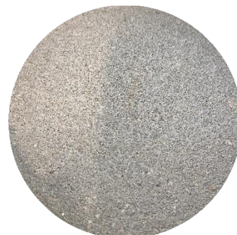
Rys 27. Przełam próbki CEM II/B-S 42,5 R-NA
