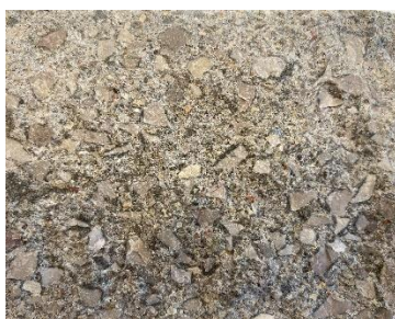
Rys 18. Przełam próbki CEM II/A-M (V-LL) 52,5 N
