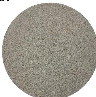
Rys 29. Wygląd powierzchni warstwy licowej CEM III/A 42,5 N- LH/HSR/NA
