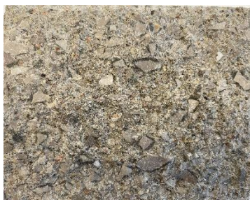
Rys 25. Przełam próbki CEM II/B-S 42,5 R-NA
