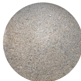
Rys 24. Wygląd powierzchni po badaniu w soli CEM II/A-LL 42,5 R
