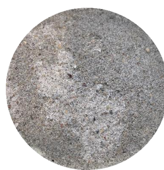
Rys 21. Wygląd powierzchni po badaniu w soli CEM II/A-M (V-LL) 52,5 N
