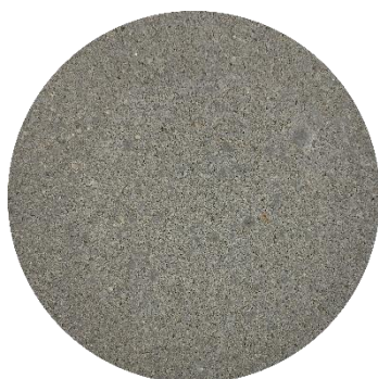
Rys 19. Wygląd powierzchni licowej CEM II/A-M (V-LL) 52,5 N
