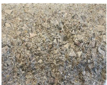
Rys 22. Przełam próbki CEM II/A-LL 42,5 R
