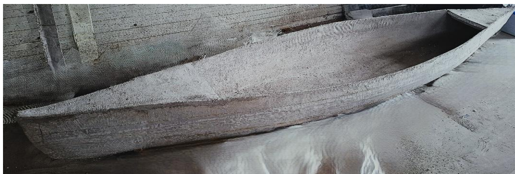
Rys. 7. Zdjęcie przedstawiające kajak z formy-pozytyw
