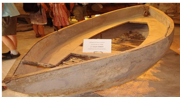
Rys. 1. Żelazocementowa łódź Josepha Lambota w muzeum Brignoles [7]
