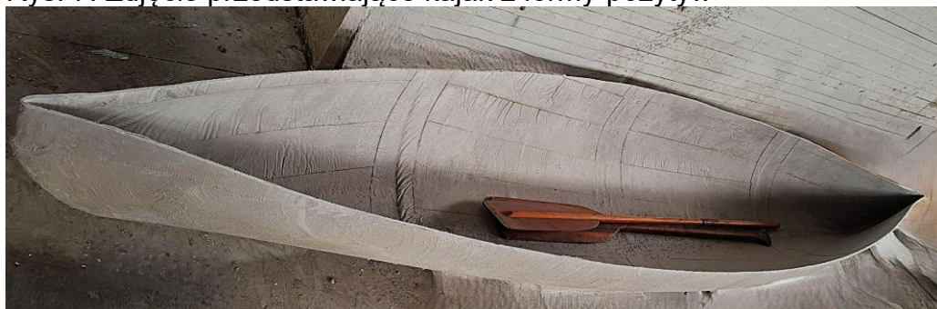
Rys. 8. Zdjęcie przedstawiające kajak z formy-negatyw
