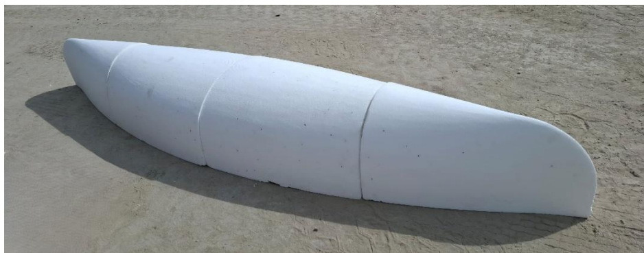
Rys. 6. Forma ze styroduru
