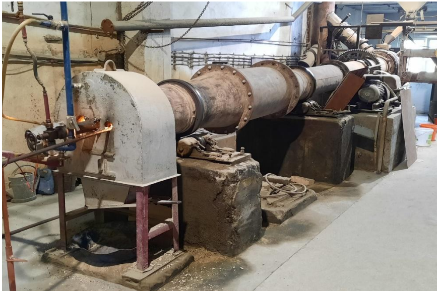
Rys. 1. Piec obrotowy w skali półtechnicznej; wymiary: \Phi 0,38m x 7m; zakres temperatur 800 - 1450°C; wydajność 50 kg/h; prędkość obrotowa pieca: 0.5-4.0 rpm, paliwo: olej opałowy.
