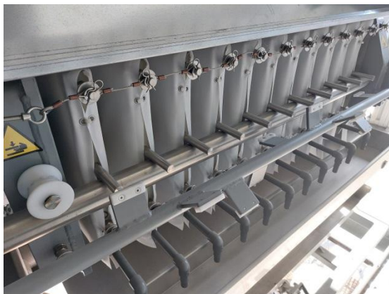
Fot. 4 Prasa filtracyjna
