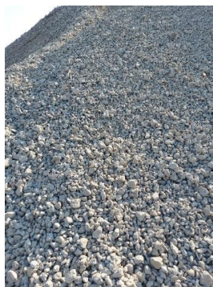
Rysunek2. Przykład kruszywa powstałego z przekruszenia betonu
