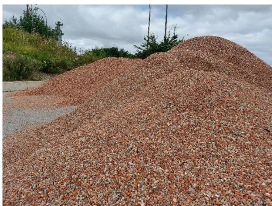
Fot 1. Magazyn kruszyw z recyklingu
