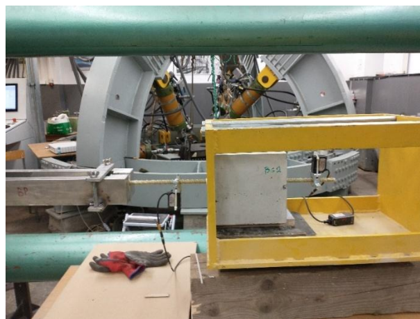
Rys. 3. Stanowisko do badania pull-out przyczepności prętów do betonu
