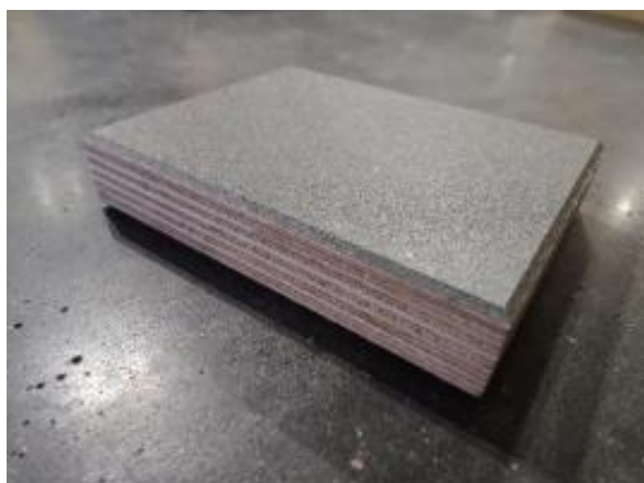
Fot. 19. Sklejka brzozowa 15-warstwowa powlekana warstwą polipropylenu (560 gr na m 2 )
