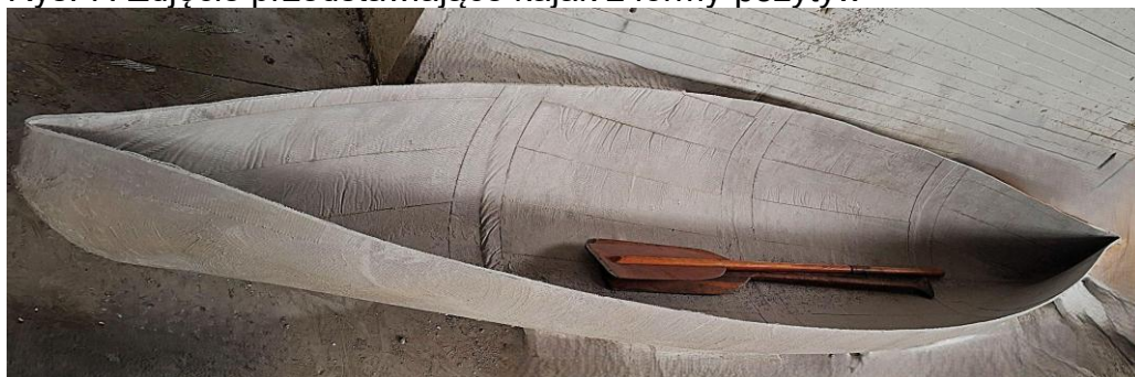
Rys. 8. Zdjęcie przedstawiające kajak z formy-negatyw
