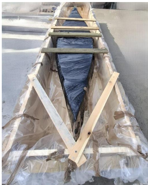
Rys. 3. Zdjęcie oryginalnego kajaka w formie
