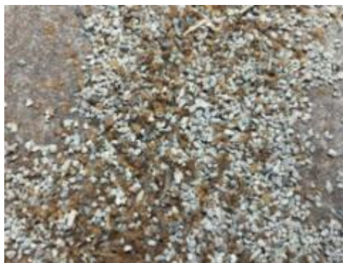
Rys 5. – Zanieczyszczenia organiczne w kruszywie recyklingowym – podstawa do odrzucenia partii kruszywa
