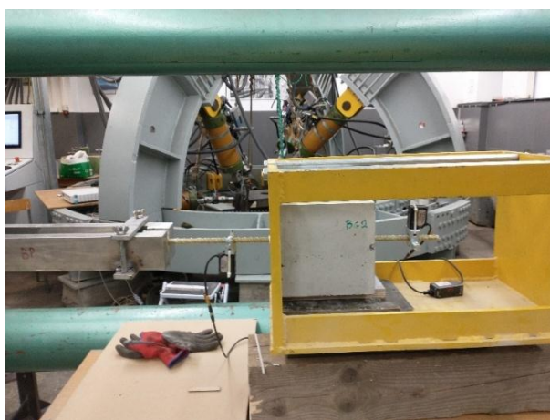
Rys. 3. Stanowisko do badania pull-out przyczepności prętów do betonu
