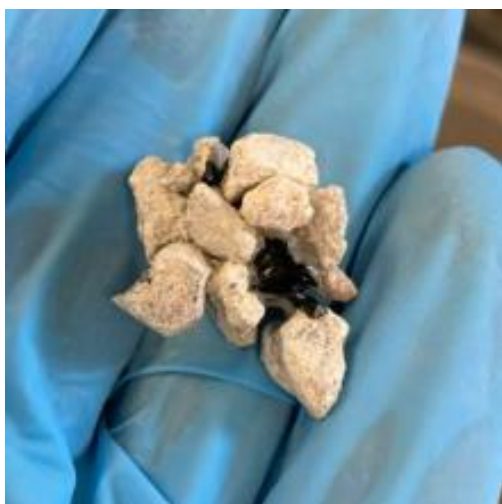
Rys. 3 - Zanieczyszczenia bitumiczne - podstawa do odrzucenia partii kruszywa
