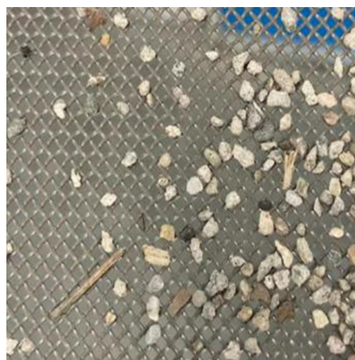
Rys. 4 - Zanieczyszczenia organiczne/bitumiczne - podstawa do odrzucenia partii kruszywa
