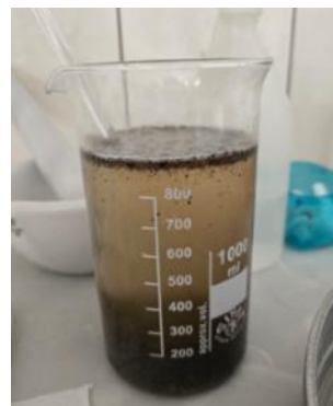
Rys 6. - Zanieczyszczenia organiczne w kruszywie recyklingowym – podstawa do odrzucenia partii kruszywa
