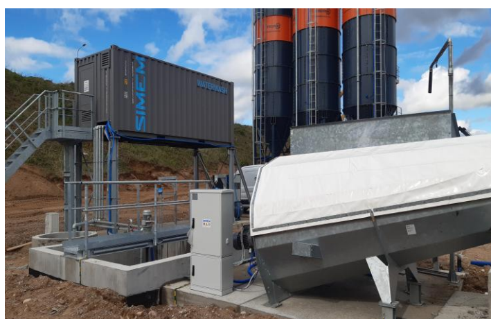
Fot. 1 Zespół recyklingu BETONWASH + WATERWASH
