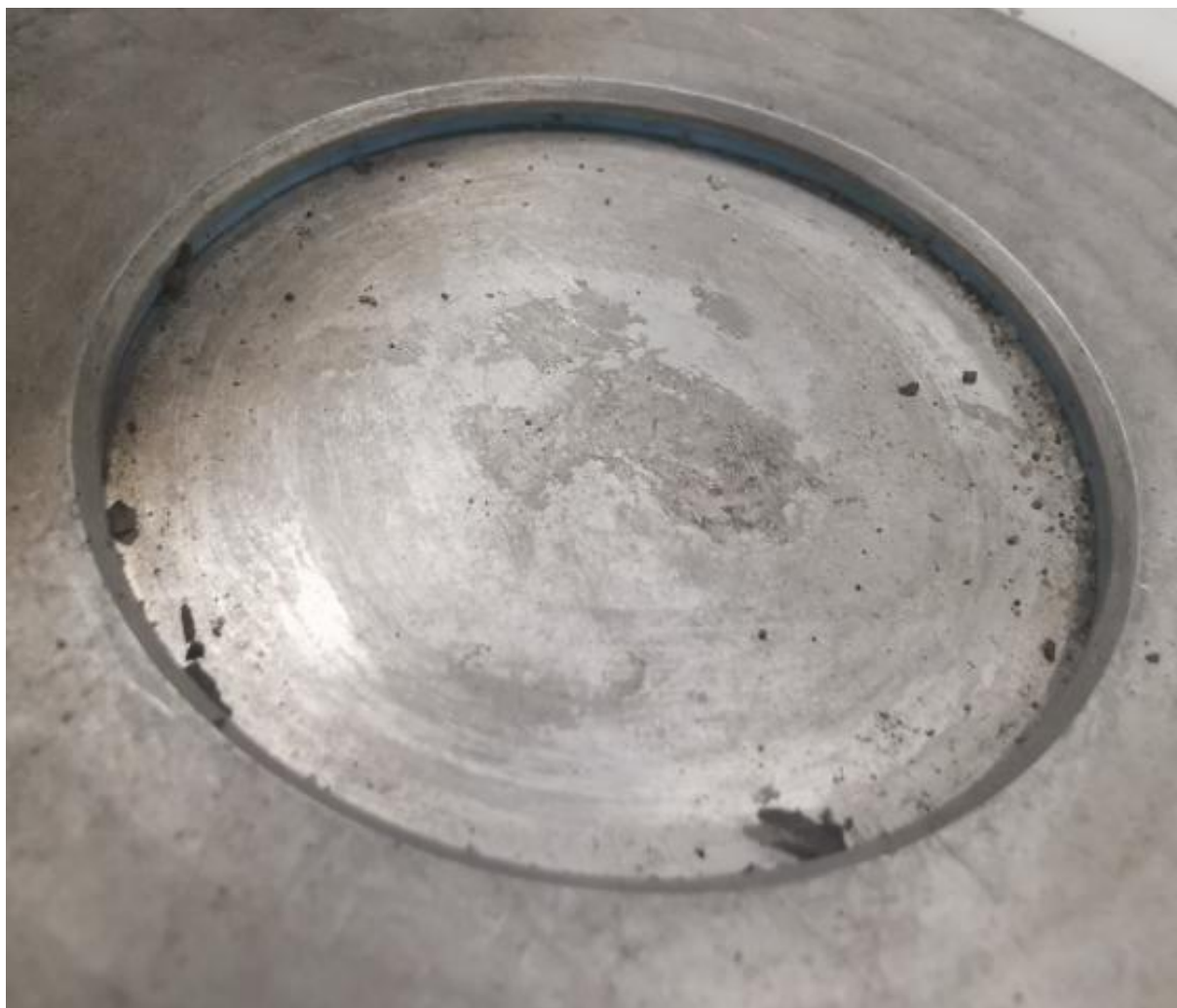
Fot. 4.2 Widok sensora wibroakustycznego: na środku okrągły element to membrana wymuszająca drgania; niebieskie otoczenie membrany – elastyczne uszczelnienie naprężone prostopadle.
