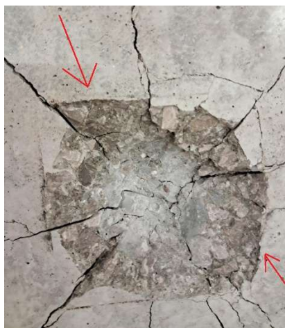
Fotografia 4 Wpływ mocowania próbki na kształt stożka wyłomu. Wskazane proste krawędzie wynikają z zablokowania tworzenia się krateru przez blachę mocującą
