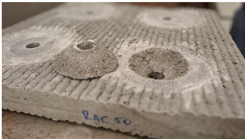
Rys. 6 Badanie pull-out betonu drukowanego
