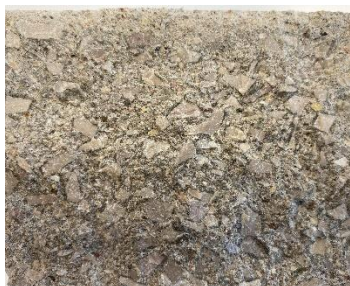
Rys 28. Przełam próbki CEM III/A 42,5 N- LH/HSR/NA
