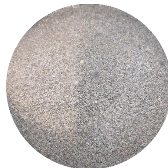
Rys 17. Wygląd powierzchni po badaniu w soli CEM I 42,5 R
