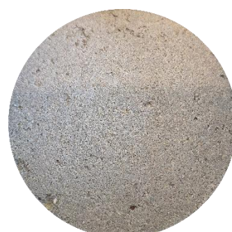
Rys 30. Wygląd powierzchni po badaniu w soli CEM III/A 42,5 N- LH/HSR/NA
