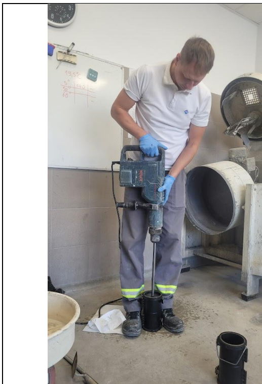
Rys.4. Zagęszczanie próbki przy pomocy młota uderowego
