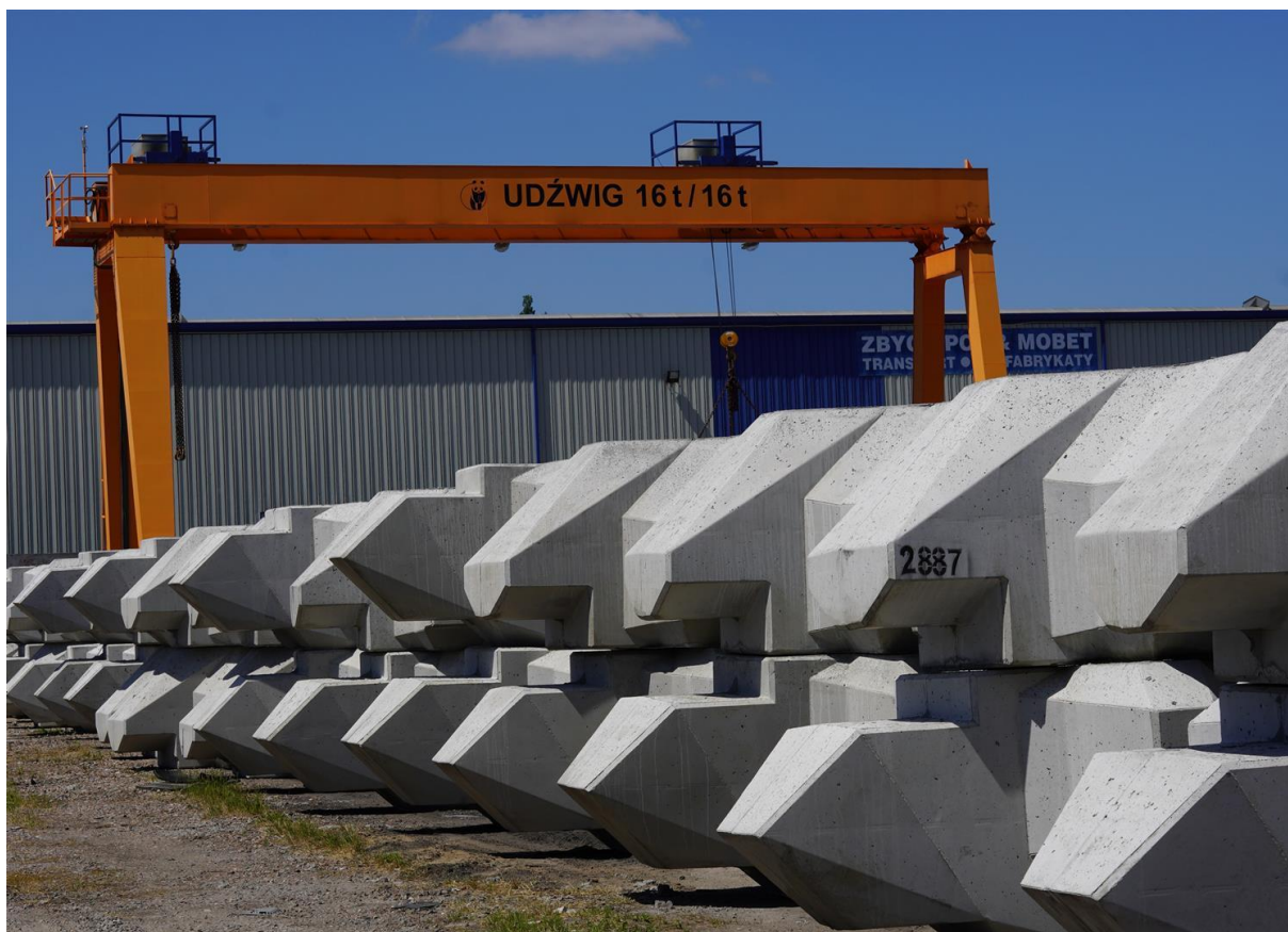
Zdjęcie 19: Wyprodukowane prefabrykaty XblocPlus – plac składowy producenta
