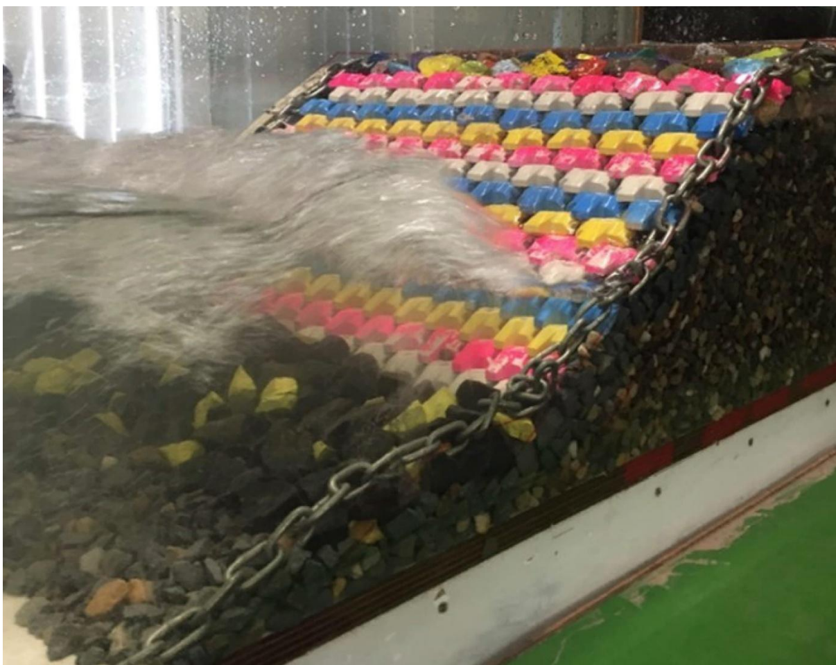
Zdjęcie 3: Fizyczne testowanie modelu w laboratorium wewnętrznym
