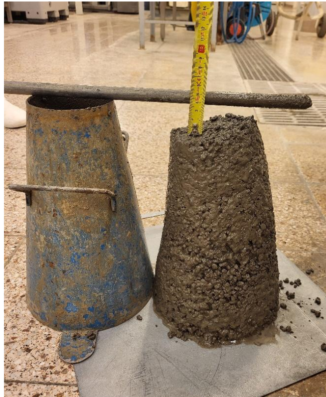
Fotografia 3. Badanie konsystencji betonu lekkiego metodą opadu stożka
