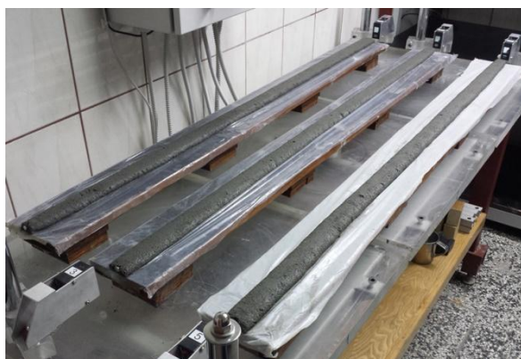
Rys. 4. Stanowiska badawcze do badania skurczu druku 3D: a) wariant 1 - próbki uformowane poprzez wyłaczanie pojedynczych warstw materiału z maszyny przyrostowej, bez dodatkowych zabiegów zagęszczania; b) wariant 2 - próbki zaformowane w półokrągłych korytkach liniowych i zagęszczone z wykorzystaniem stolika wibracyjnego.
