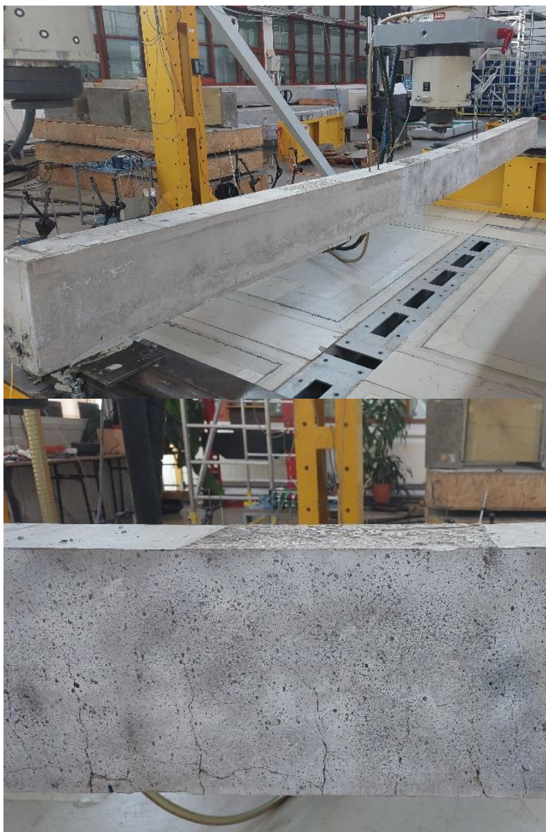
Fot. 3. Postać zniszczenia badanych belek.
