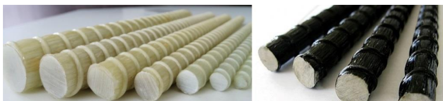
Rys. 4. Przykład prętów GFRP (a) i CFRP (b) [21]
